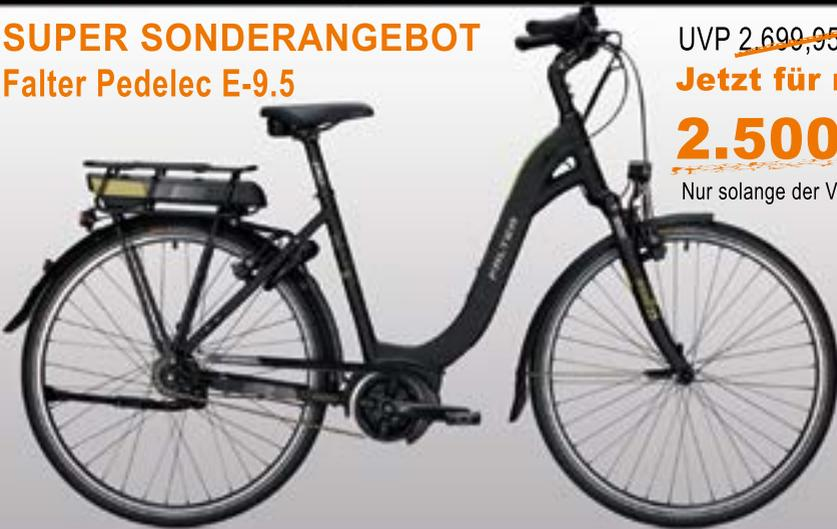
// Antrieb: Bosch Mittelmotor Active Plus (50 Nm Drehmoment) // 500 Wh. Akku im Gepäckträger verbaut // 8-Gang Shimano Nexus Schaltung mit oder ohne Rücktrittbremse // Magura HS-11 hydraulische Felgenbremsen für sicheres Abbremsen //
